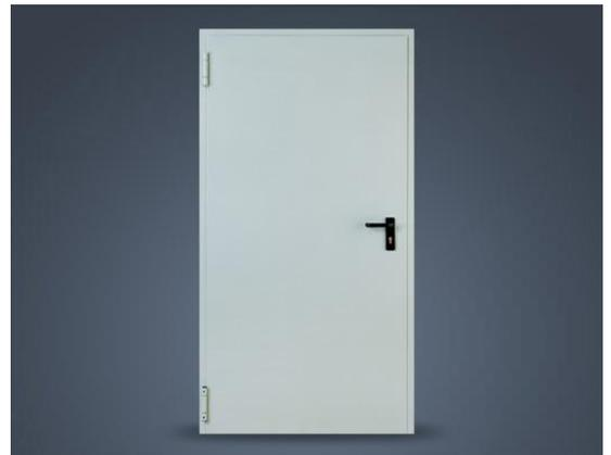
Le porte saranno dotate di maniglia in polimero con cilindretto per chiave di chiusura, e nei casi previsti dalla normativa, con maniglione antipánico installato dalla parte contraria alla via di fuga. Le porte saranno dotate di molla di auto-chiusura al fine di garantire che dopo ogni passaggio, sia immediatamente ripristinata la protezione ignifuga di sicurezza.
