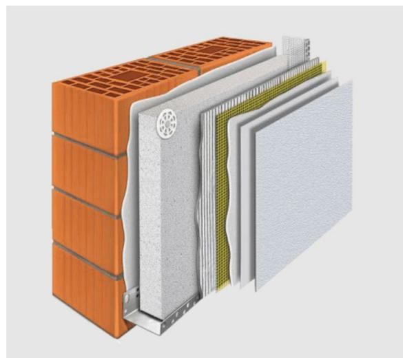
Al fine di garantire un'elevata efficienza energetica sia **INVERNALE** (per ridurre le dispersioni di calore) che **ESTIVA** (per evitare il surriscaldamento) abbiamo scelto di realizzare un sistema a **CAPPOTTO TERMICO in EPS ADDITIVATO CON GRAFITE da 14 cm.**
